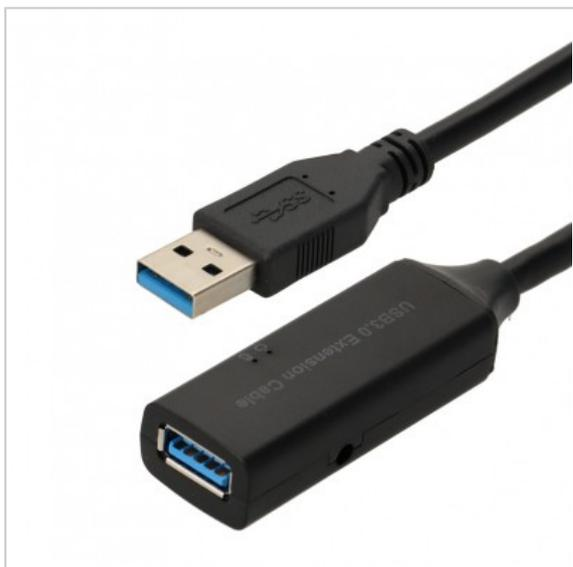
USB 3.2 GEN 1 - USB superspeed Débit de données : 5 Gbps Auto-alimenté pour la version 5m. Une alimentation fournie pour les versions 10, 15 et 20m (1 ampli sur le cordon pour 10m, 2 amplis pour 15m et 3 amplis pour 20m) Cascadable 3 fois Connecteurs plaqués nickel Conducteurs cuivre
